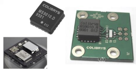
图示 2: MS9010.D (LCC20: 内部和封盖) 和 RS9010.A (LCC20 在评估板上).
